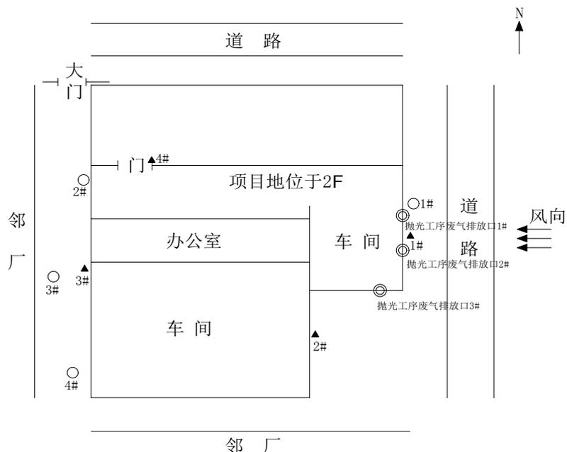
注：◎抛光工序废气 1#、2#、3# 排放口，○激光切割、激光点焊工序无组织废气采样点，
