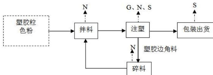
图 3-3 电塑胶制品生产工艺及产污环节流程图
