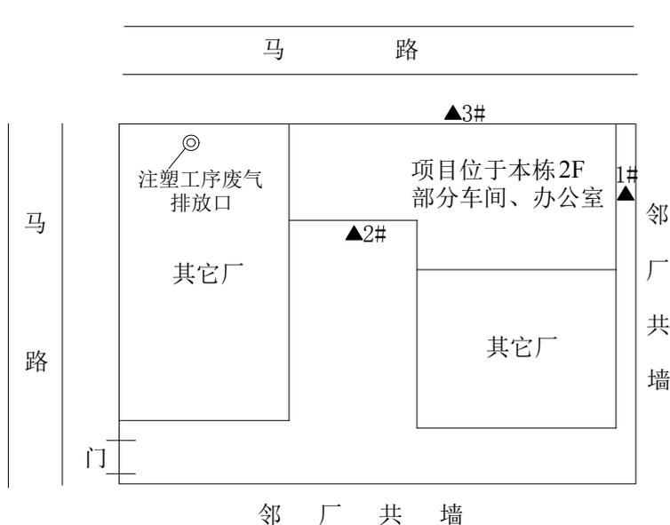
注：◎注塑工序废气排放口，▲噪声监测点
