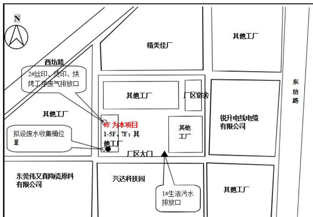
图3-1 厂区平面布置及监测点位
